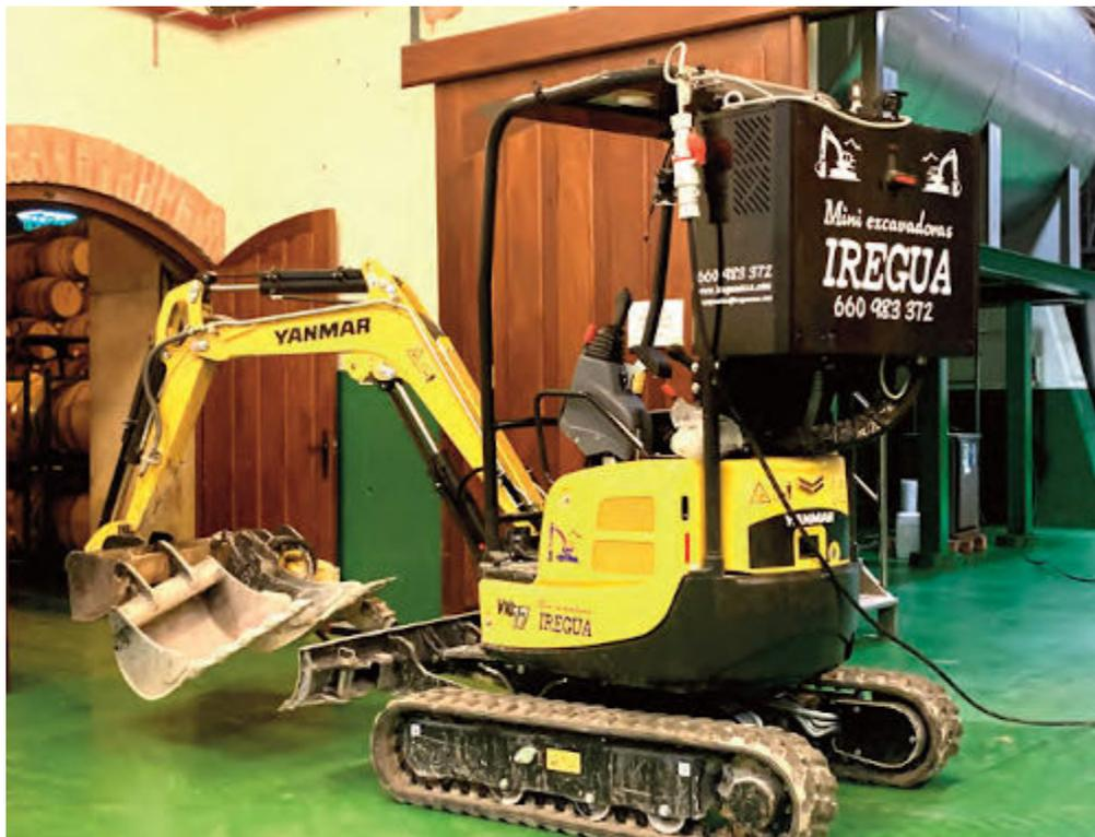
**Miniescavadora YANMAR VIO17 equipada con accesorio ZAINOMOTORE ([www.zainomotore.com](http://www.zainomotore.com)) para añadir el modo híbrido enchufable con dos modos de trabajo: eléctrico y térmico (diésel). “**
